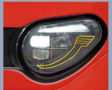
LED-Scheinwerfer hat die Funktionen Scheinwerfer und Abblendlicht. Das vordere Blinklicht nutzt die neueste Stream-Light-Technologie
