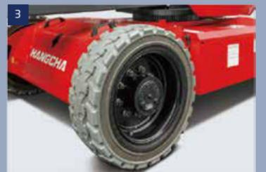
3 Reifen: schaumgefüllte Reifen mit guter Geländeleistung
