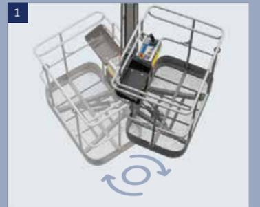
1 Korb: kann in einem Winkel von 140° nach links und rechts gedreht werden
